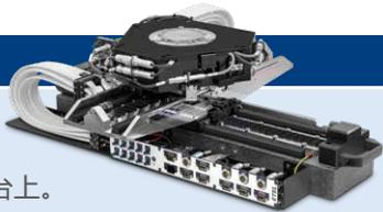
Z3TM让OEM厂商可从昂贵和陈旧的压电解决方案中迁移到新平台，避免磁滞难题，同时在高动态性能工作的同时提供纳米级的高分辨率、高精度和高重复精度。该模块自带样品找正功能，可相对设备头另用“俯仰”和“摆动”轴提高圆晶平面度。
